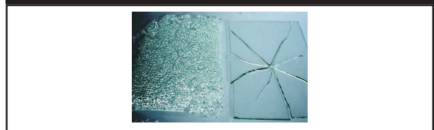
Şekil 6. Temperli cam ve tavlanmış cam arasındaki kırılma davranışı farklılığı
